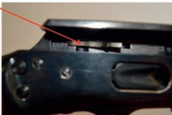
Marlin ejector in situ.
