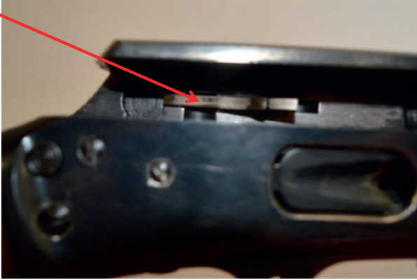
Marlin ejector in situ.
